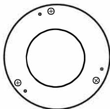
3) На ней расположены 3 винта с полукруглой головкой и крестообразным шлицем и 3 утопленных винта под шестигранный ключ. В этом случае винты под шестигранный ключ являются стопорными, а винты с крестообразным шлицем – регулируемыми.
