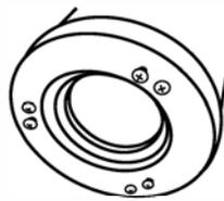
2) На ней расположены 6 винтов с полукруглой головкой и крестообразным шлицем, 3 из которых выступают над поверхностью. В этом случае те винты, которые выступают над поверхностью, являются стопорными, а оставшиеся 3 – регулируемыми.
