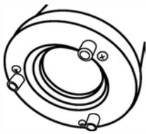
1) На ней расположены 3 винта с полукруглой головкой и крестообразным шлицем и 3 гайки большего размера. В этом случае винты выполняют функцию стопорных, а гайки – регулирующих элементов.
