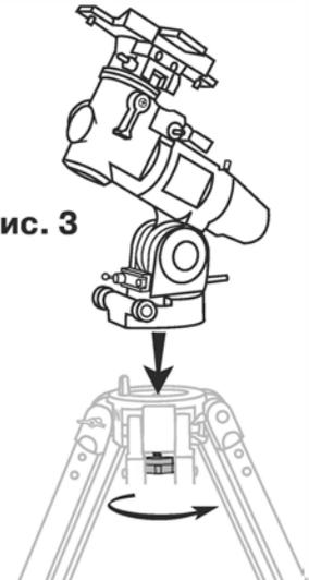
Примечание: Если не удастся правильно установить опору, отпустите винты азимутальной регулировки так, чтобы между ними образовался достаточный зазор для установки опоры на штатив подтяните винты.
